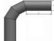
Отвод 90° сварной двухсекционный
